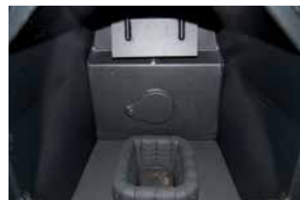
Cámara de combustión
