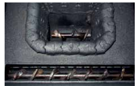
Extractor de ceniza: cámara de combustión
