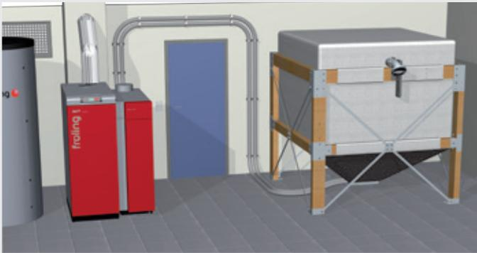
El sistema de silo textil es una opción flexible y sencilla para almacenar pellets. Existen 9 superficies diferentes disponibles (de 1,5 m x 1,25 m hasta 2,9 m x 2,9 m) con una capacidad de 1,6 a 7,4 toneladas, dependiendo de la densidad a granel.
